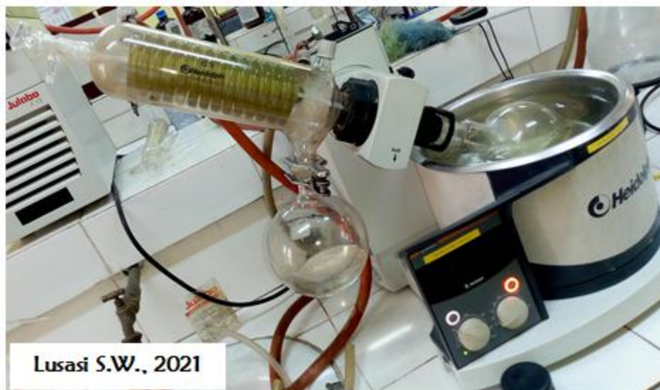
Fig. 4. Dispositif complet d'évaporateur rotatif utilisé lors d'extraction d'huiles de poissons Schilbe grenfelli (©Lusasi S.W., 2021)
