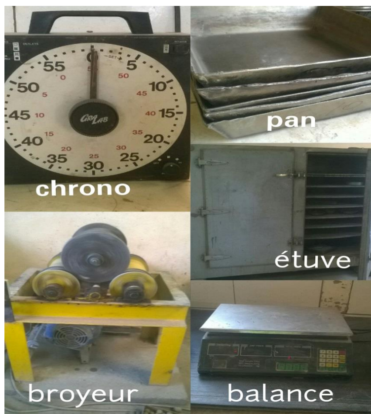
Fig. 5. Matériel utilisé au laboratoire (chronomètre, broyeur à boulet, balance, étuve et pan)
