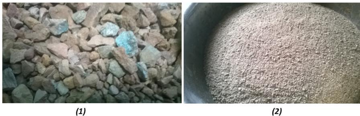
Fig. 3. (1) minerais alimenté au concasseur et (2) Passant au tamis de 8 mesh après concassage
