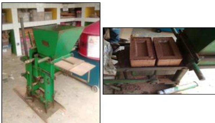
Fig. 2. Presse hydraulique avec le moule de compactage
