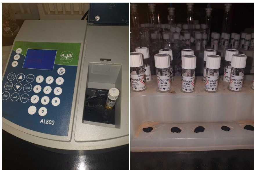
Fig. 7. Détermination de la DCO par spectrophotomètre
