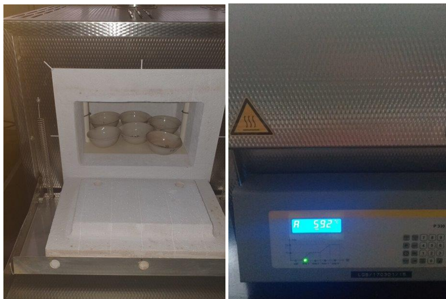
Fig. 5. Calcination des échantillons dans un four à moufle
