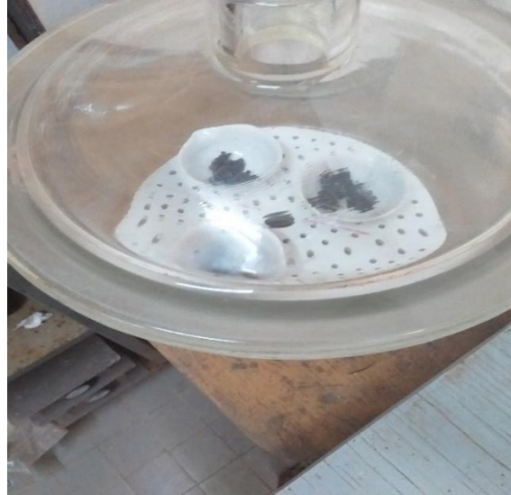
Fig. 4. Refroidissement des échantillons dans un dessiccateur
