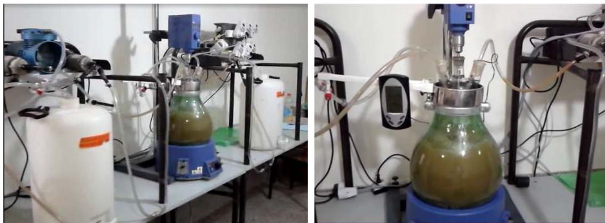
Fig. 4. Vue d'ensemble du pilote et du réacteur SBR
