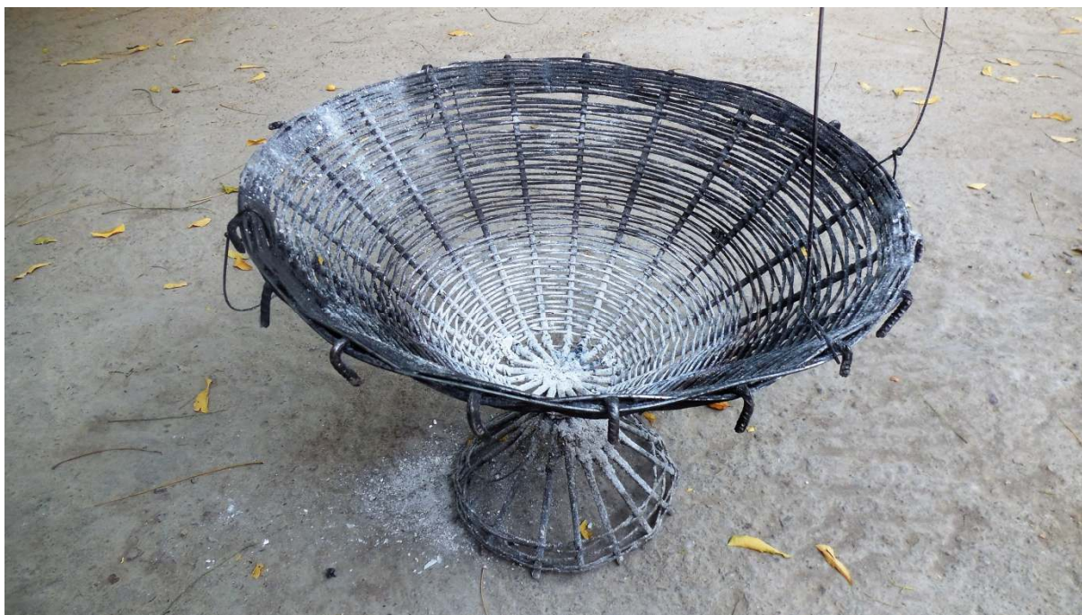
Photo n°3, ganoune, foyer mobile fabriqué par de matériaux de récupération de pneus usés
