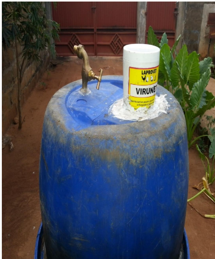
Fig. 3. Cloche du digesteur familial fabriqué
