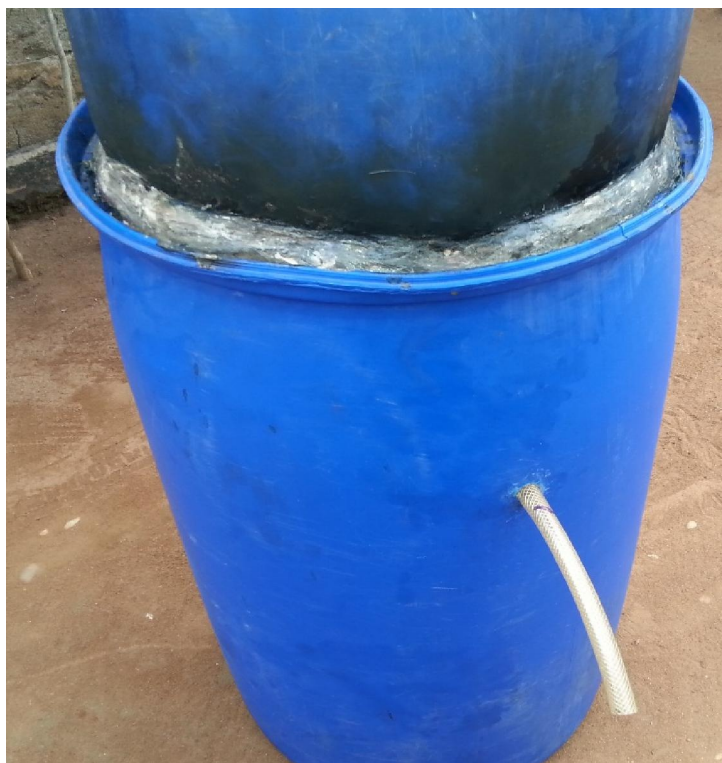
Fig. 2. Socle du digesteur familial fabriqué
