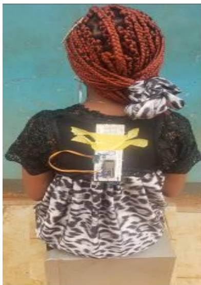
Fig. 11. Prototype du dispositif électronique textile détecteur de posture
