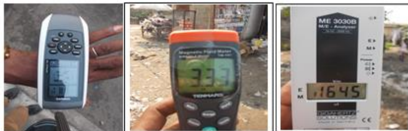
Fig. 2. De gauche à droite: Le téléphone SAMSUNG J CORE, l'analyseur de fréquence TENMARS et l'analyseur de fréquences GIGAHERTZ
