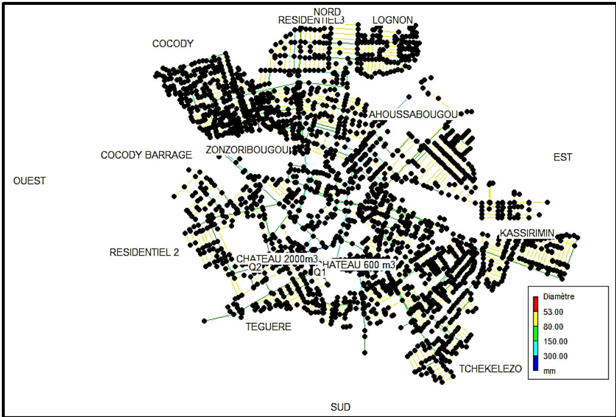
Fig. 4. Réseau hydraulique d'AEP de la ville de Korhogo modélisé sous EPANET
