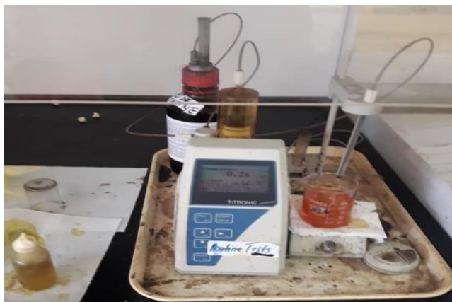
Fig. 6. Détermination de la salinité de l'eau par titrage de l'ion Chlorure, \text{Cl}^- par l'ion argent, \text{Ag}^+ ; en présence de Chromate de potassium, \text{K}_2\text{CrO}_4 .
