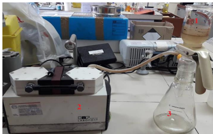
Fig. 5. Dispositif de filtration sur cellule Büchner
