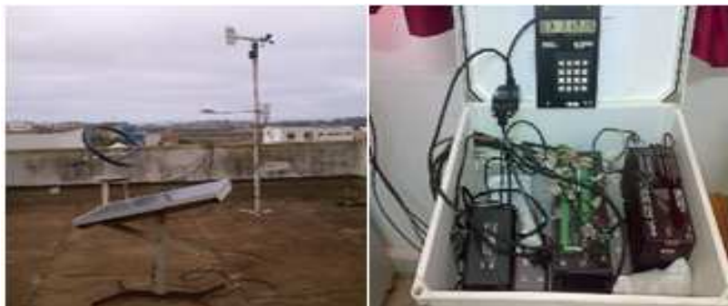
Fig. 1. Station météorologique équipée de la centrale d'acquisition Cambell de type CR10X
