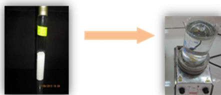
Figure 02: Mise en suspension des NPs du ZnO
