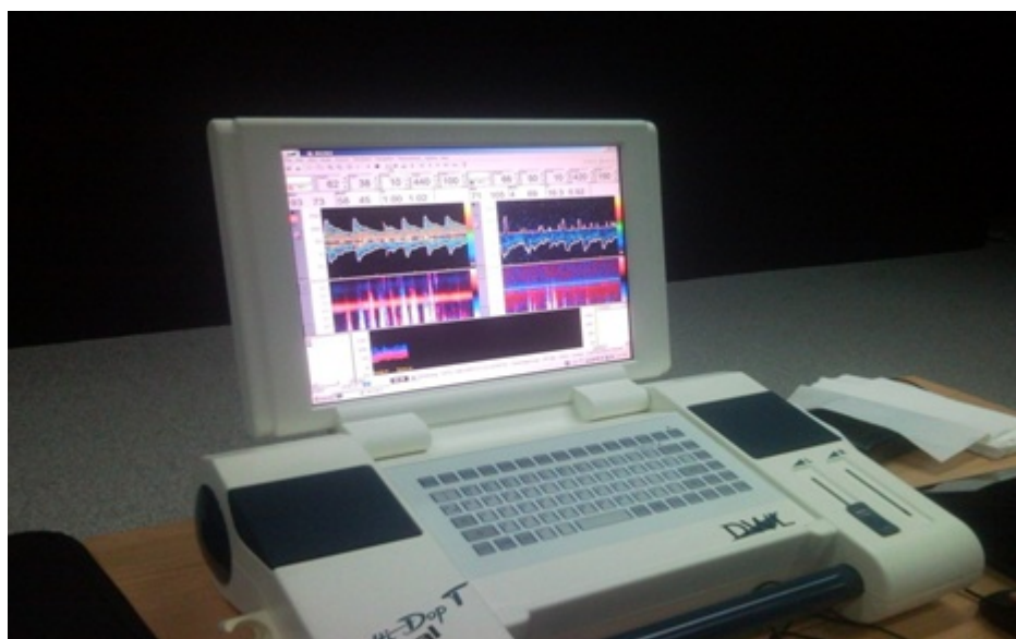
Figure 2: Doppler pulsé utilisé pour enregistrer le signal de la vitesse d'écoulement de sang.
