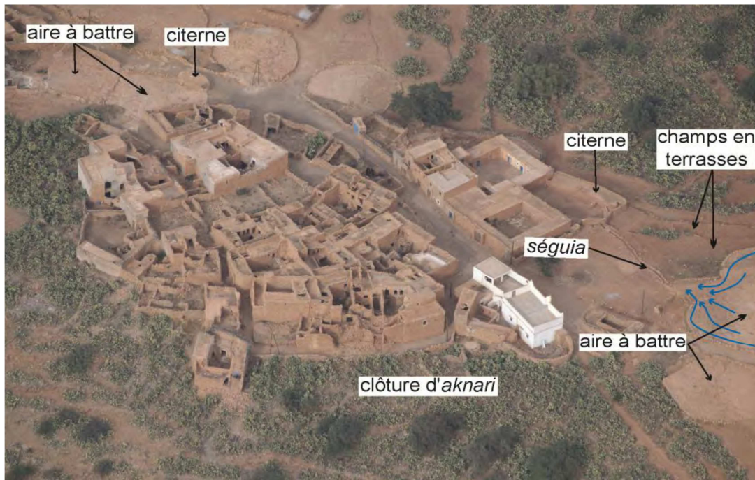
Fig. 2: Alimentation des matfias par l'eau pluviale qui tombe sur les aires à battre dans l'Anti-Atlas occidentale (photo d'HUMBERT 2009).
