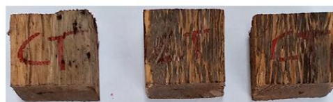
c- éprouvettes de 20 \times 20 \times 20 \text{ mm}^3
