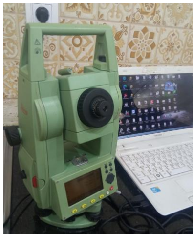
Fig. 8. Récupération de données d'une station totale vers l'ordinateur
