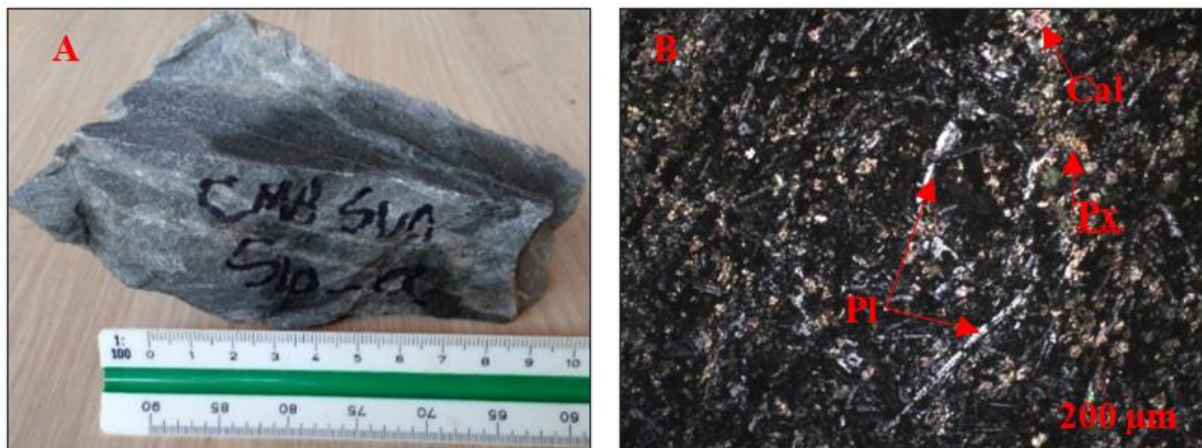
Fig. 18. Aspect macroscopique et microscopique du basalte
