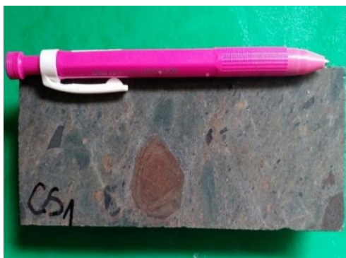
Fig. 35. Aspect macroscopique et microscopique du conglomérat
