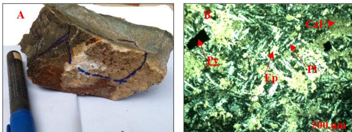
Fig. 20. Aspect macroscopique et microscopique du basalte andésitique
