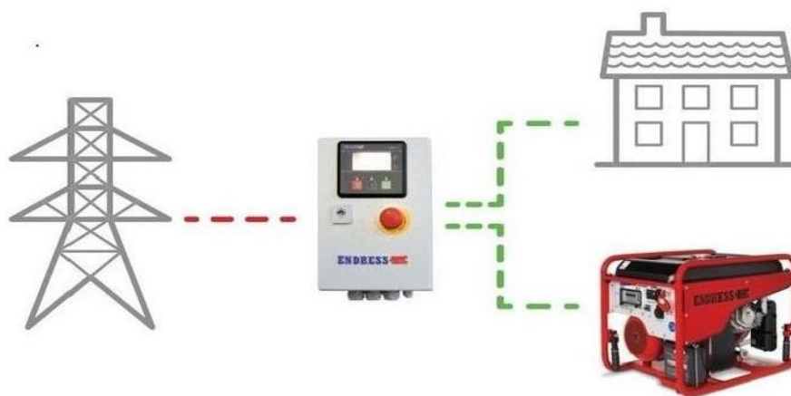
Fig. 5. En cas de coupure du réseau électrique (SNEL): Le groupe électrogène est démarré à la main
