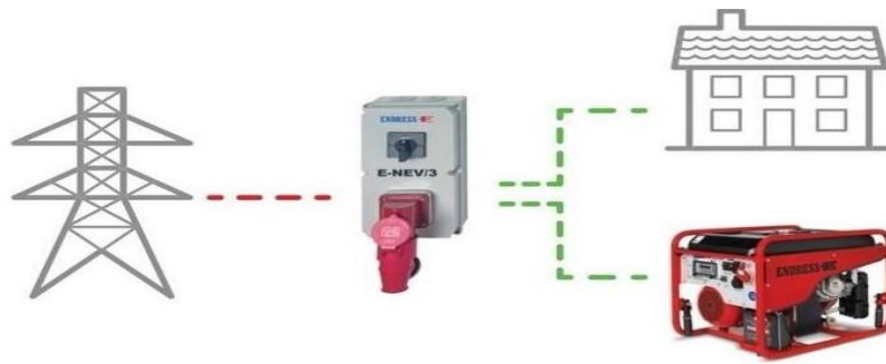
Fig. 6. En cas de coupure du réseau électrique (SNEL): Le groupe électrogène démarre automatiquement
