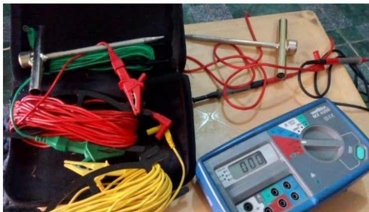
Fig. 4. Equipements utilisés pour la mesure de la résistance de terre du poste HT de Lingwala/Kinshasa
