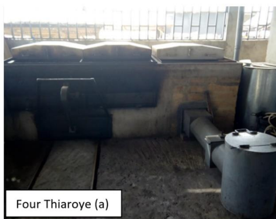
Fig. 3. Photographies du four Thiaroye (a) et du four traditionnel (b) utilisés pour les tests de fumage
