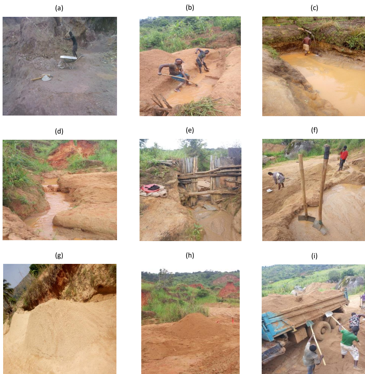
Fig. 3. Vues partielles de la carrière d'exploitation. (a) creusement du sable par un artisan, (b) lavage du sable, (c) étang de stockage d'eau dans la carrière, (d) lavage du sable par les eaux provenant des étangs, (e) bassin de rétention du sable lavé, (f) pelles manuelle utilisé par les artisans pendant l'exploitation du sable, (g, h) tas de sables déjà lavés, stocké et prête à commercialisation, (i) commercialisation du sable à Nepenet.
