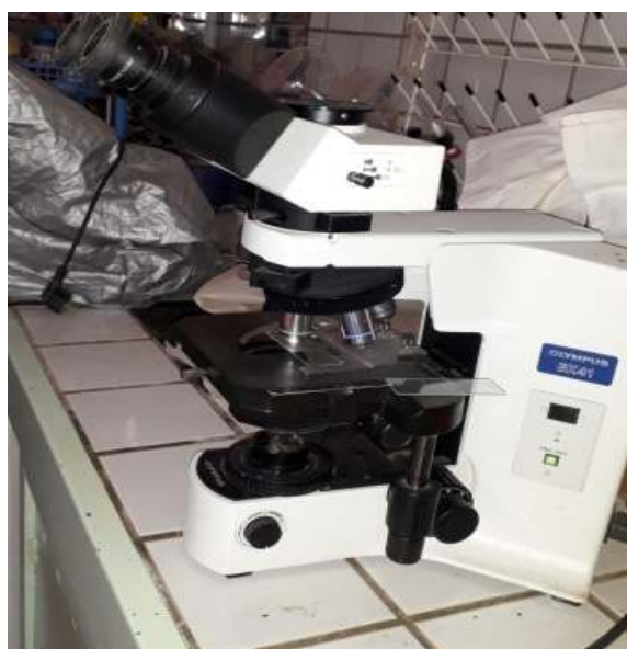
Fig. 3. microscope optique à lumière polarisée, marque OLYMPUS
