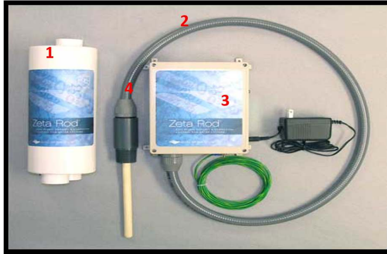
شكل (3) جهاز توليد جهد زيتا (1- وعاء التفاعل، 2- مجهز قدرة، 3- قطب الأرضي، 4- قطب زيتا)
