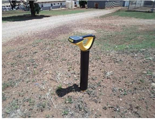
Photo 4: Vue de récepteur de VlocPro2, pose au sol lors des travaux de prospection sur terrain
