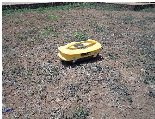
Photo 3: Vue de l'Émetteur du VlocPro2, pose au sol lors des travaux de prospection sur terrain
