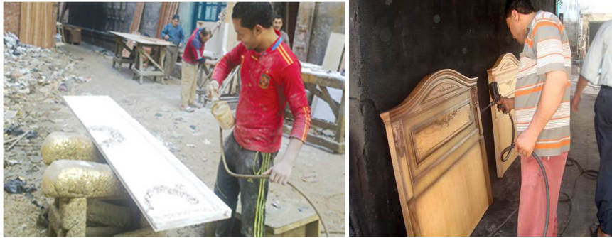
شكل (7) نماذج لوسائل الرش التقليدية المستعملة من قبل العاملين بالقطاعات الصغيرة
