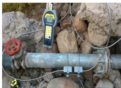
Fig. 2. Débitmètre portable ultrasonique à temps de transit PrimeFlo-T
