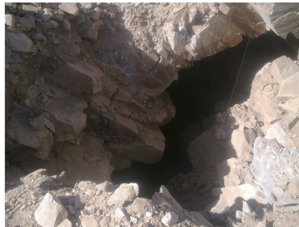
Fig. 8. Premier percement dans le vide des anciennes chambres d'exploitation
