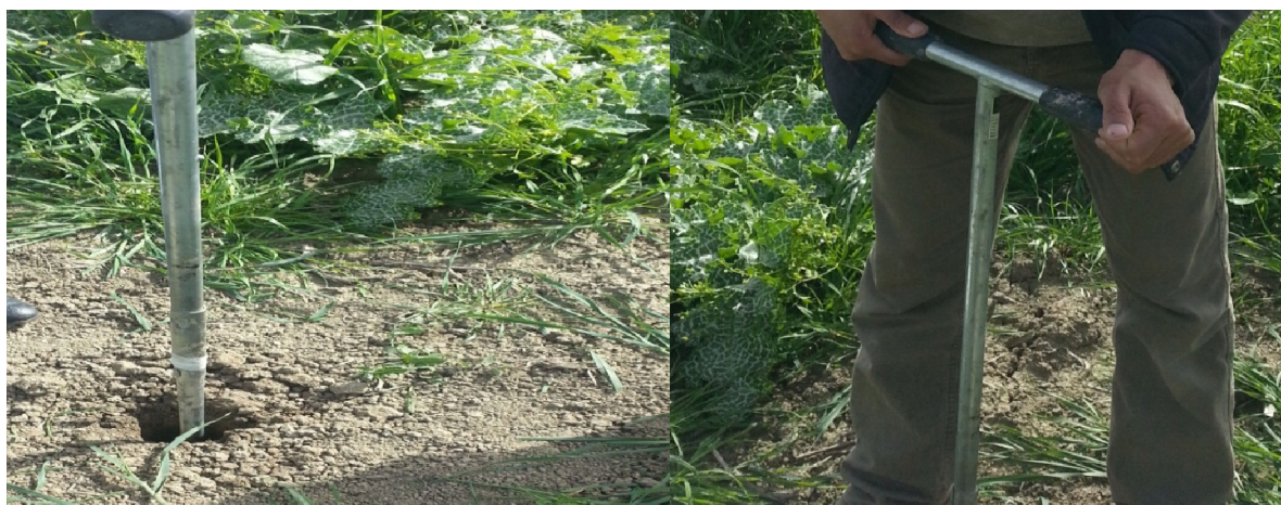
Fig. 2. Prélèvement du sol à l'aide d'une tarière hélicoïdale, à deux profondeurs : 0 – 15 cm et 15 – 30 cm
