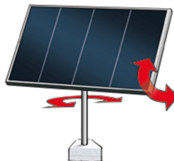
Fig. 2. Schéma explicatif du mécanisme de rotation à deux directions.
