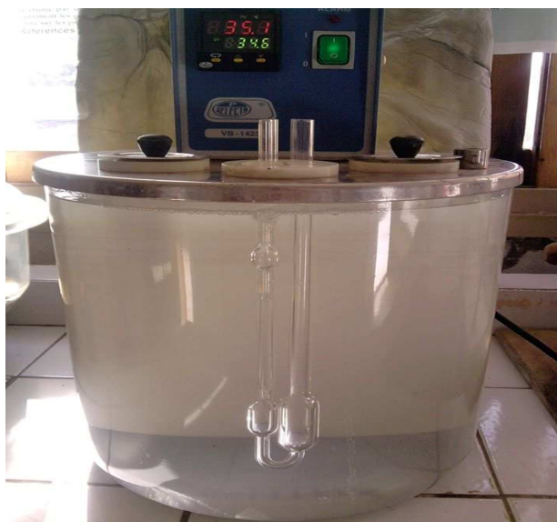
Fig.2. Appareil des mesures viscosimétrique
